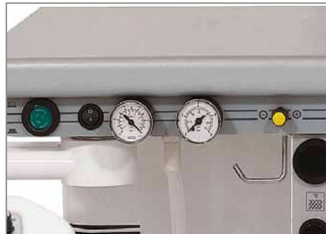
Manomètre et Vacuumètre (dans l'avant de l'unité).
